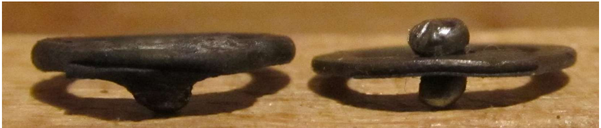
Afbeelding 22: links een “wedge-rivet” en rechts een ronde klinknagel. Het voordeel van de driehoekige klinknagel is dat 1 kant van het ringetje mooi plat wordt waardoor de maliënkolder fijner draagt.
